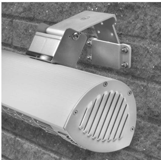
konzoly. Podívejte se na obrázek. Zasuňte závěsnou konzolu do stěnové konzoly co nejdál - malý otvor v závěsné konzole vyčnívá pod stěnovou konzolou. Terasový ohřívač zajistěte: zašroubujte přibalenou krátkou křídlovou matici co nejdále do malého otvoru v závěsné konzole.
