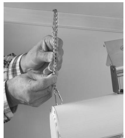
Kette in die Aufhängeösen an der Decke ein. Wenn Sie die Kette durch die Aufhängeöse ziehen und den zweiten Karabinerhaken an der Kette befestigen, können Sie den Strahler eventuell etwas höher hängen (siehe Abb.).
